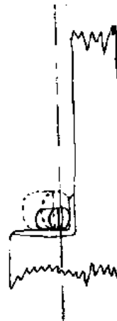
Se il diametro della freccia è alto, la linea di scorrimento della freccia (linea di forza) si discosta dalla linea di mira (asse della freccia)
